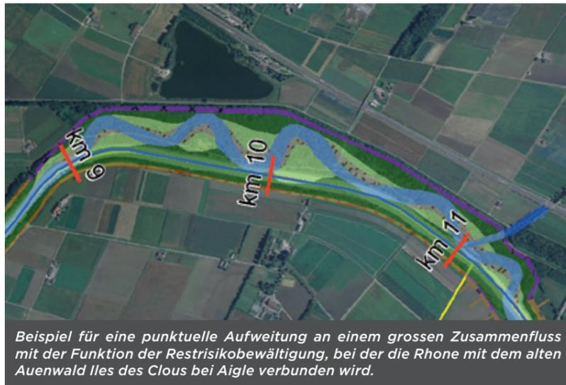
Beispiel für eine punktuelle Aufweitung an einem grossen Zusammenfluss mit der Funktion der Restrisikobewältigung, bei der die Rhone mit dem alten Auenwald Iles des Clous bei Aigle verbunden wird.
